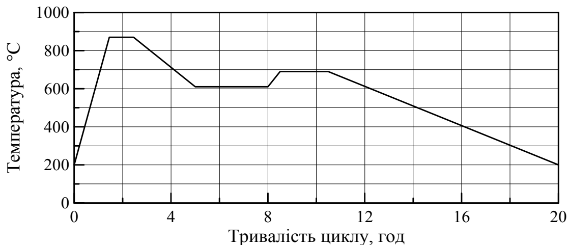
Рис. 1. Режим ступінчастого відпалу хромомарганцевого чавуну
